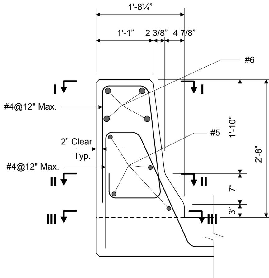
Figure 7.3.4.2.1-1 Barrier Configuration
