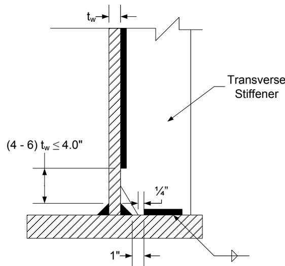
**Figure 6.5.5.2.2.1.3-3 Transverse Stiffener Detail**
