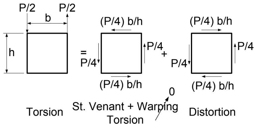
**Figure 6.4.8.3.1-4 Torsion Components – Box Section**
