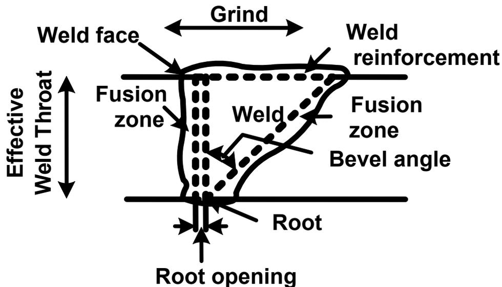
**Figure 6.6.4.3.3.2.1-2 Groove Weld Nomenclature**
