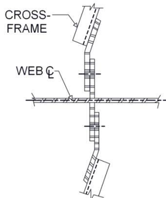
**Figure 6.3.2.9.6.3.1-3 Bent Gusset Plate**
