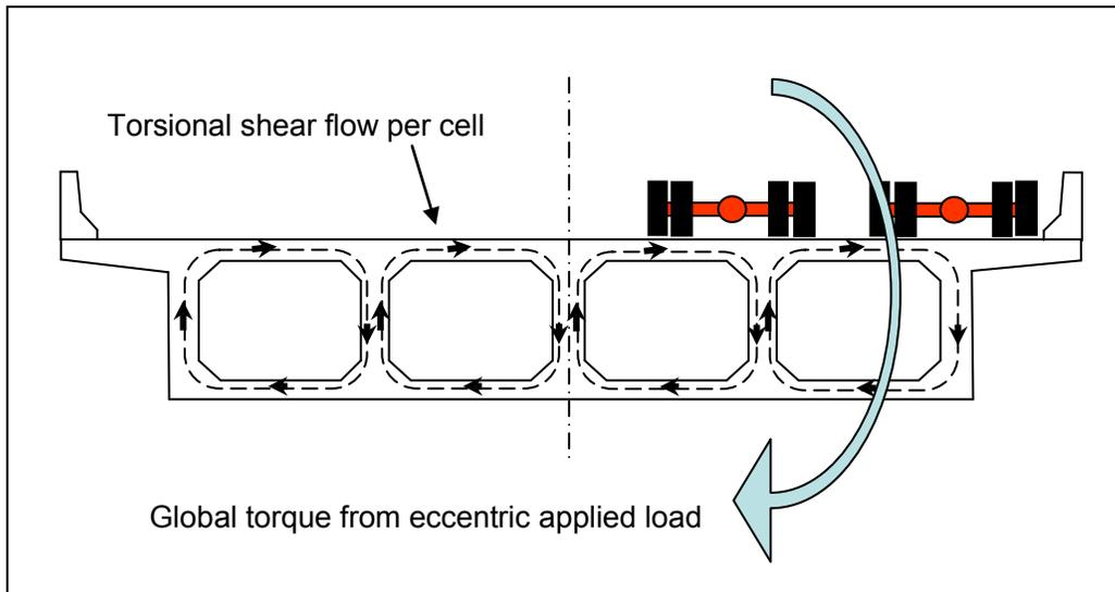
**Figure 5.10.6.1.2-1 Shear Flow in Multi-cell Box**
