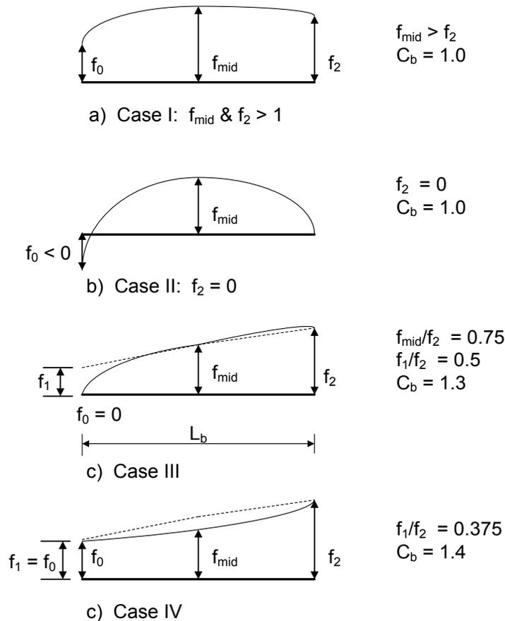
**Figure 6.5.6.2.2.2-4 Moment Gradient Modifier,  $C_b$  – Example Cases**
