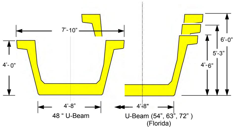
**Figure 5.10.3.1.2-2 U-Beam Sections**
