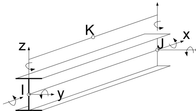
Figure 4.5.3.3.2.3.1-1 Beam Element
