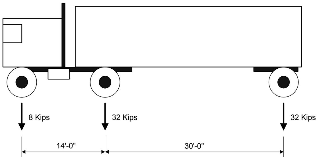
**Figure 3.4.4.1-1 Fatigue Load**
