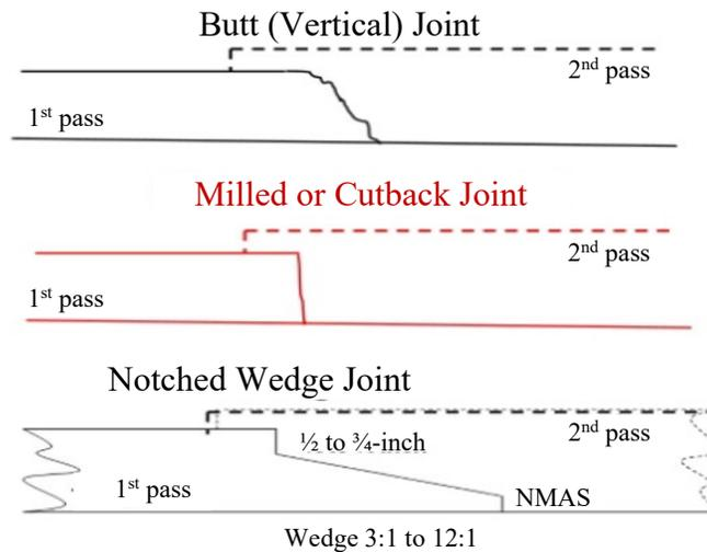
**Figure 3. Longitudinal Joint Types.**
